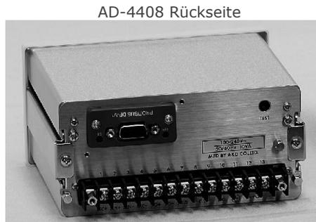
Die modulare Bauweise ermöglicht die einfache Installation der notwendigen Schnittstelle.
