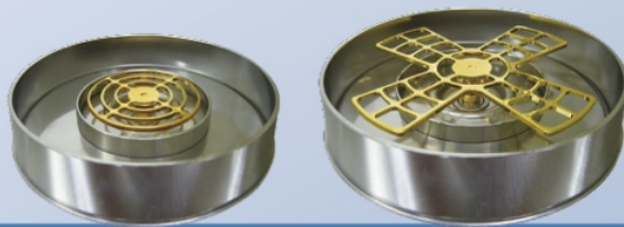
Spezielle Aufnahmen zum Wiegen von PM-Filtern
