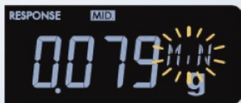
Blinkt bei Unterschreitung der Mindesteinwaage
