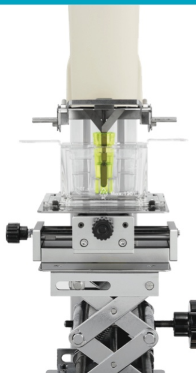
Sensor im 2ml Probengefäß (SV-1A)
