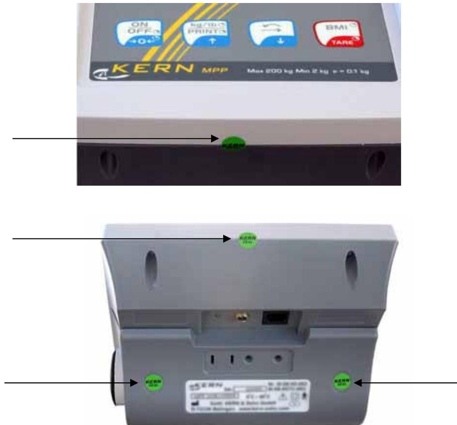
Bei der Stuhlwage ist die Wägezelle ebenfalls auf der Unterseite mit einem Sicherungsdraht mit Plombe gesichert.
