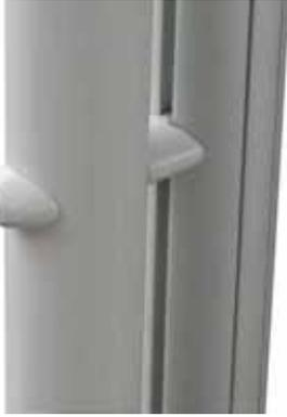
Die Klappe des Körper-Größenmessers kann mit einem 2 mm Schraubendreher angezogen oder etwas gelöst werden, je nachdem, ob der Benutzer eine feststehende Klappe wünscht, oder die Klappe sofort nach Benutzung sich selbsttätig wieder nach unten senken soll.
